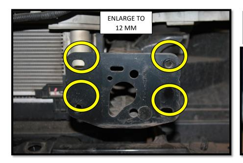
REMOVE THE NUTS FROM THE BACK OF THE FLANGE
